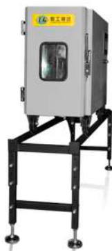
Камера повышенных температур (нагрев от комнатной температуры до +300)
