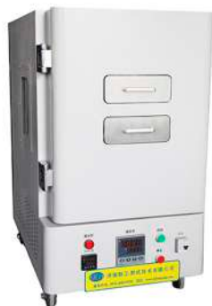
Термокамера для маятниковых копров Нагрев до +300 С
