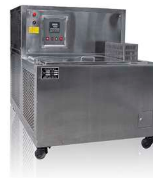
Для вертикальных копров Охлаждение до -80 или -90 С
