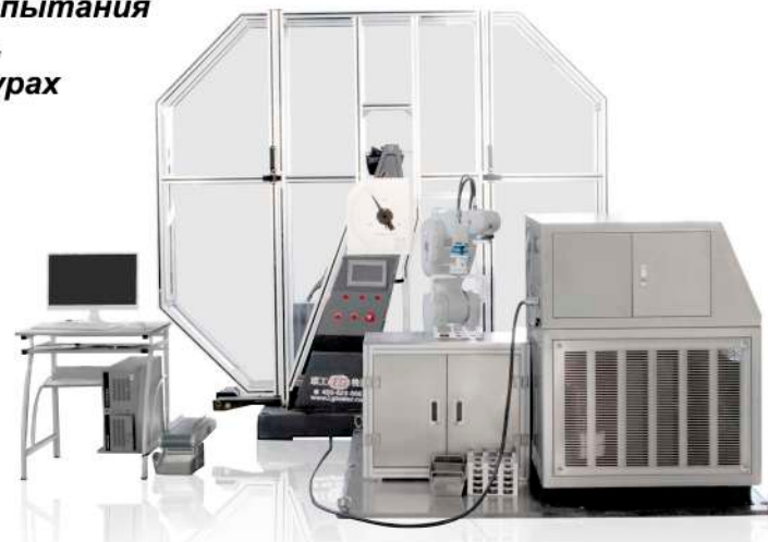
Роботизированный комплекс (маятниковый копер, криостат, робот) модели JB-1200-7/0.7
