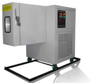
Термокриокамеры (охлаждение до -30, -40, -60, -80, -100 и нагрев образцов до +150, +300)
