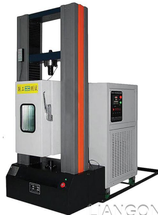
Серия GDX: камера повышенных и пониженных температур
