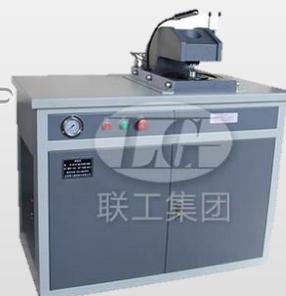
– Машина для испытания на выдавливания по Эриксену с ручным управлением BT-60
