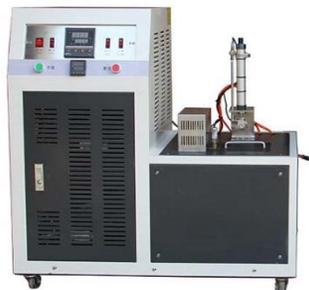
– Криостаты для определения температурного предела хрупкости резины моделей DCL-70, LG-7040
