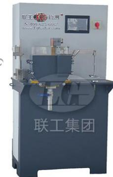
– Полуавтоматическая установка для испытания на абразивный износ по ASTM G105 с использованием мокрого песка и резинового колеса с электронным дисплеем модели LGM-225
