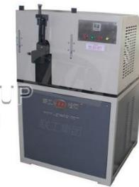
Для испытания на многократный изгиб проволоки или плоских образцов JWJ-10-3
