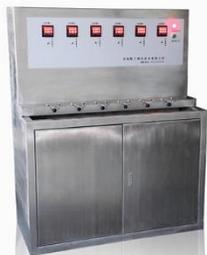
– Установка для прокаливаемости стали методом торцевой заковки модели DZ-2, DZ-4, DZ-6
