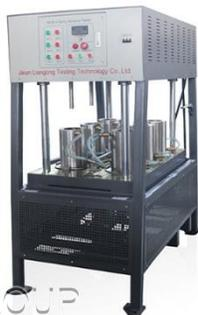
– Установка для испытания сверхмолекулярного полиэтилена на абразивный износ модели MLW-6
